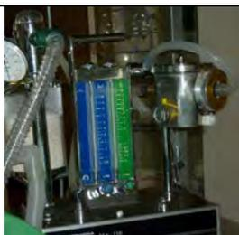
Испаритель «МИНИВАП-200» ВНЕ дыхательного контура аппарата ИН (МК-110, Япония)
